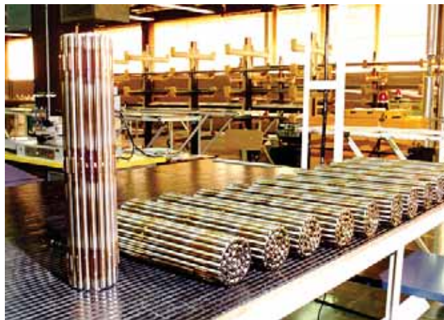
Línea de fabricación de EECC tipo CANDU en CONUAR
