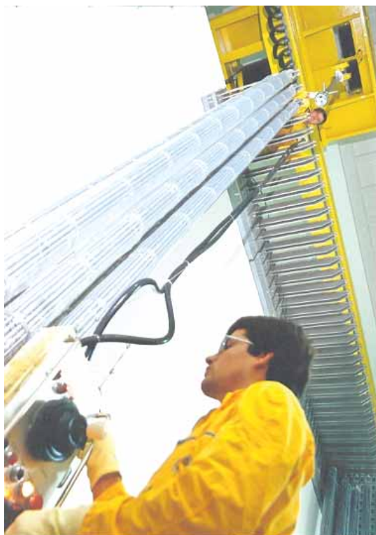
Elemento combustible de la Central Nuclear Atucha I
