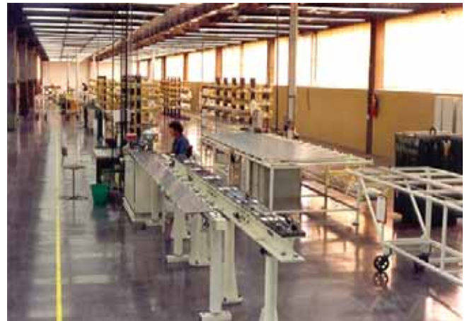
Línea de fabricación de EE.CC. tipo Atucha I en CONUAR
